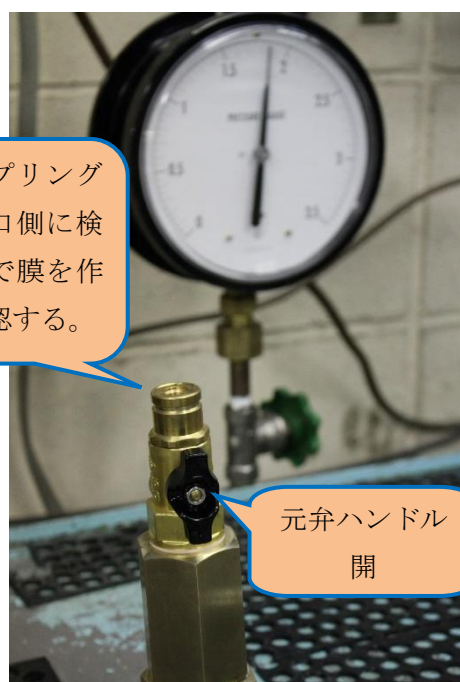
カップリング部の弁座漏れ試験
