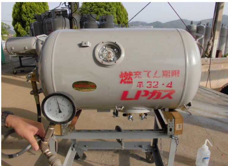
写真7 窒素ガスによる気密試験 2.28MPa
