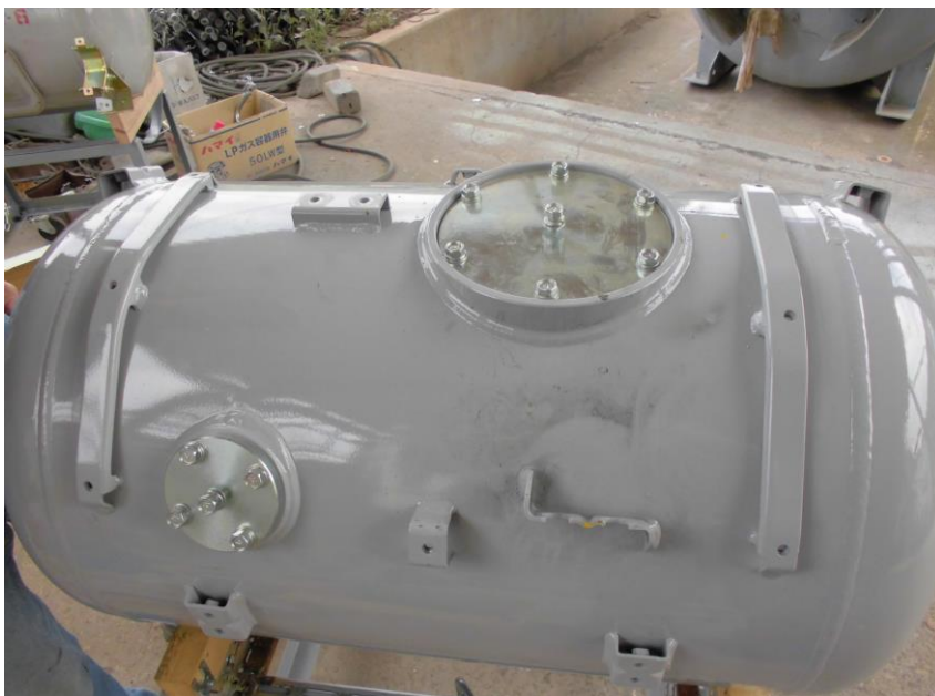
写真5 フランジ取付
